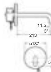
Mezclador electrónico para lavabo con sensor integrado.
