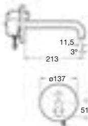
Mezclador electrónico para lavabo con sensor integrado.
