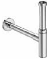
Sifón botella de 1/4" Minimal de lujo para lavabos. Tubo de 300 mm. Ref. A506403810 82,90 €
